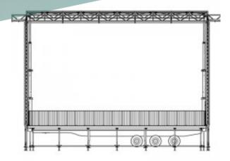
Die Kunstgriff Stage 132 ist eine Sonderanfertigung mit einer variablen Podest Fläche von 86- bis 132 m². Ebenso flexibel kann die Höhe angepasst werden. Egal ob 5 oder 7 Meter Innen Höhe.
